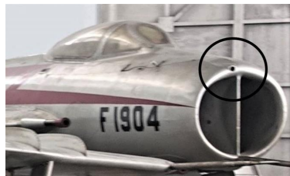
Gambar 13. Posisi Kamera KOMZ S-13 pada MIG-19 Koleksi Museum Pusat TNI-AU Dirgantara Mandala
