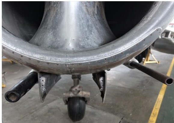
Gambar 9. Konfigurasi Senjata Pada MIG-17 Fresco Koleksi Museum Pusat TNI-AU Dirgantara Mandala Sumber : Dokumentasi Peneliti 2021
